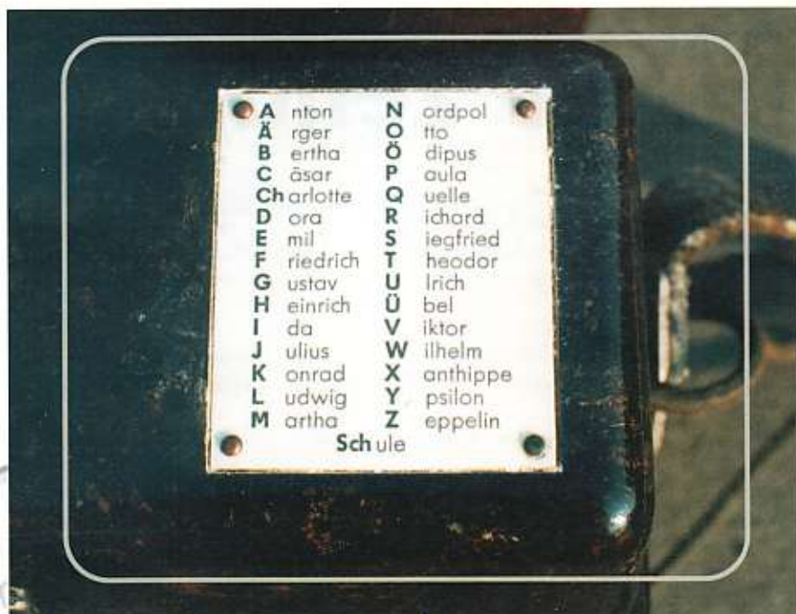
Fonetisch alfabet op de bovenzijde van Duitse veldtelefoon type Feldfernsprecher.
